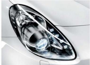
230 Proiettori Bi-Xeno con Adaptive Frontlight System
